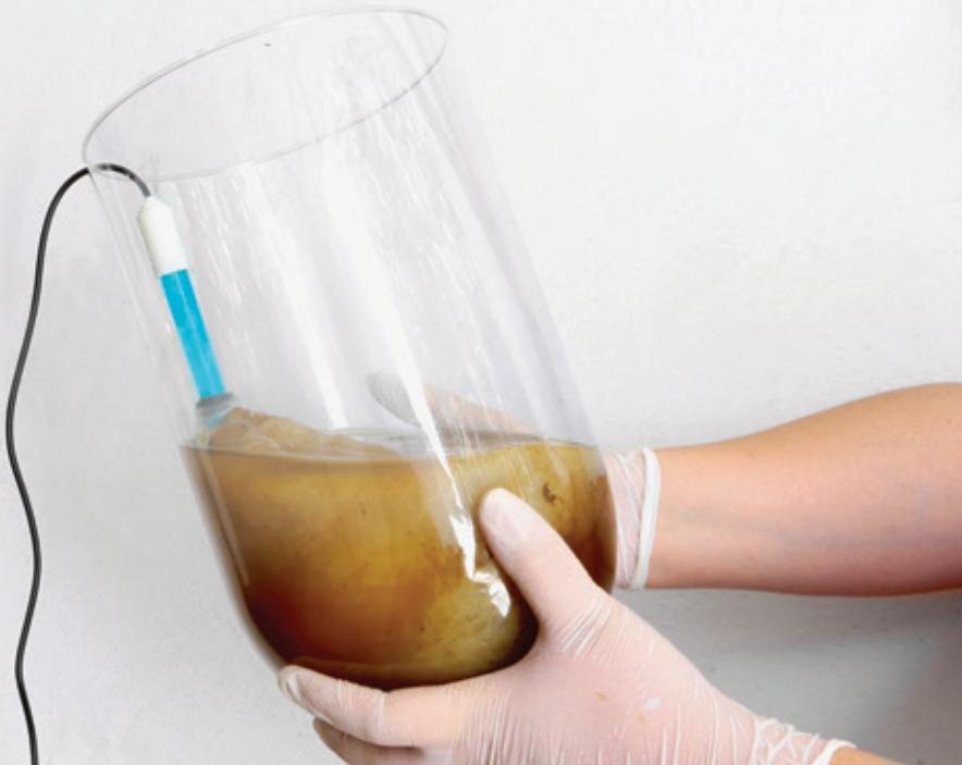
Pruebas con sensores de CO<sub>2</sub> y pH durante el proceso de producción de—
